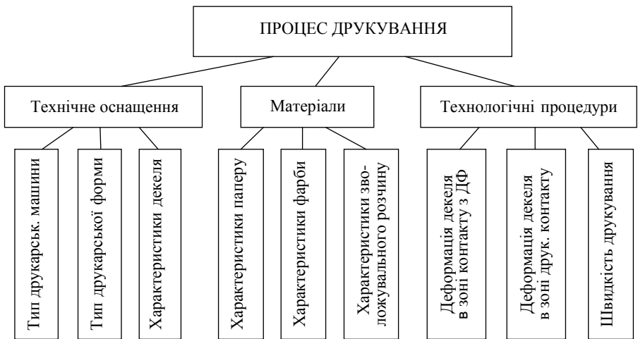
Рис. 11. Схема факторів друкування накладу плоским офсетним друком
